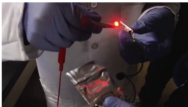
Fig. 7 Baterie din hârtie și nanotuburi de carbon
